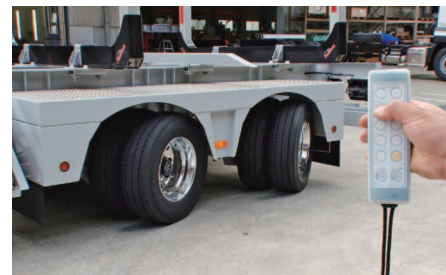
バック走行や狭曲路ではワイヤレスリモコンによる手動操舵でトレーラを容易に操作
