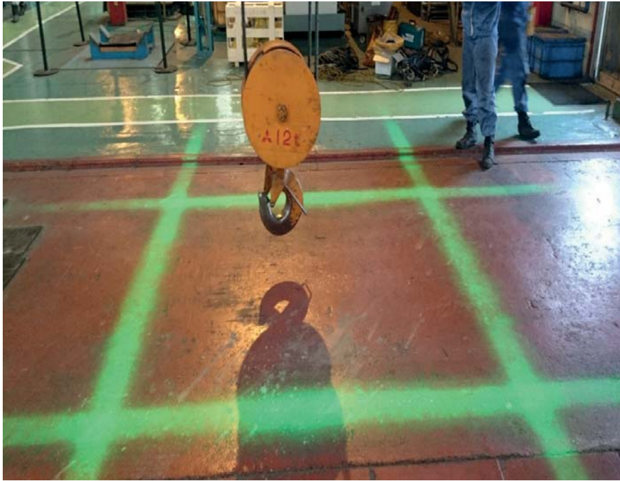
▲ クレーン下の危険ゾーンを光で明示 ▲ 光で通路を形成
