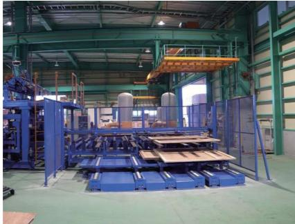
あらかじめ加工の段取りをプログラミングすることで、人手を掛けずに木箱製作が可能に。海上貨物用コンテナ積載サイズを対象として、特に量産品の製作に強みを発揮します。
