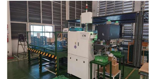
部品の形状をラインセンサで瞬時に識別し、正確且つ効率的な計数が可能です。
