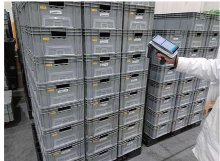
大量のコンテナバケットやパレット、台車といった生産活動に欠かせないマテハン機器の在庫管理にRFIDシステムを採用。RFIDの特徴である複数一括読み取りで効率の良い運用を実現し、早期にボトルネックを顕在化することで、お客様の計画外購買コストの抑制に貢献します。
